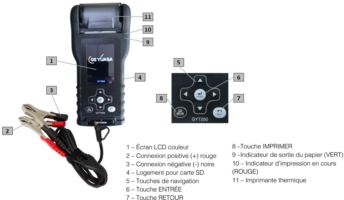
La connexion positive rouge (2) doit être raccordée à la borne positive (+) de la batterie. La connexion négative noire (3) doit être raccordée à la borne négative (-) de la batterie. Le dispositif va alors s'allumer.
